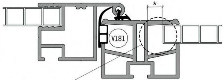
Der Rahmen des Dachfensters benötigt genügend Auflagefläche auf dem Querriegelprofil. Profil nicht bündig auf die Hohlkammerplatte schieben - Abstand\* zulassen!
