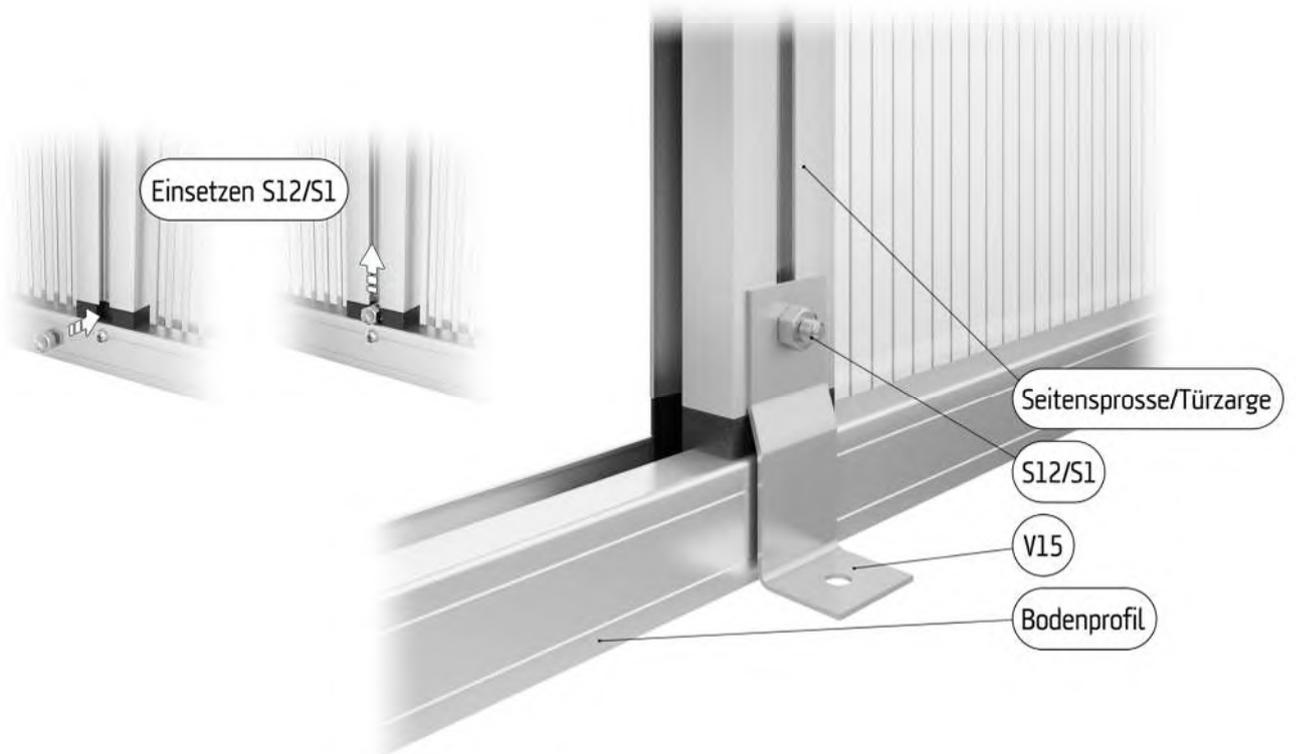
Wir empfehlen für das Aufdübeln Schlüsselschrauben inkl. Dübel zu verwenden.
