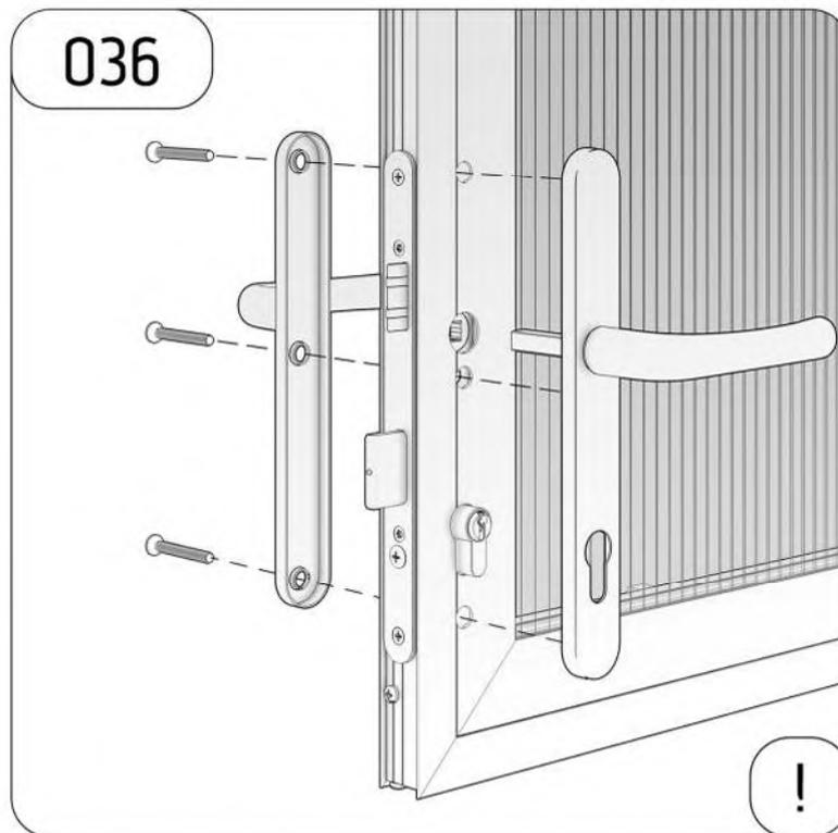
Die in der Montageanleitung angegebenen Schrauben beziehen sich auf die beigelegten Senkschrauben zur Montage der Türdrückergarnitur (= M6x45mm).
