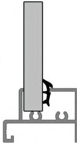
Die Dichtung 3 - 5mm zwischen das Bodenprofil und die Verglasung eindrücken.
