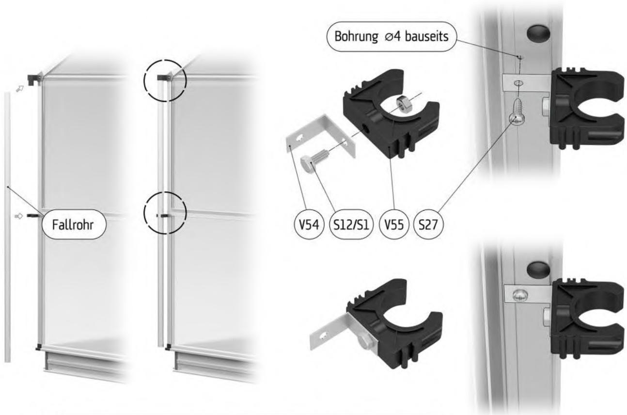
i vorn o. hinten montierbar, je nach gewünschter Position der Fallrohre
